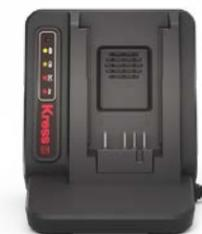
Ce chargeur permet une charge rapide et efficace avec son système de gestion et de refroidissement de la batterie SmartLink. Il charge les batteries en seulement quelques minutes tout en offrant une protection renforcée pour les cellules, assurant un cycle de vie plus long.
